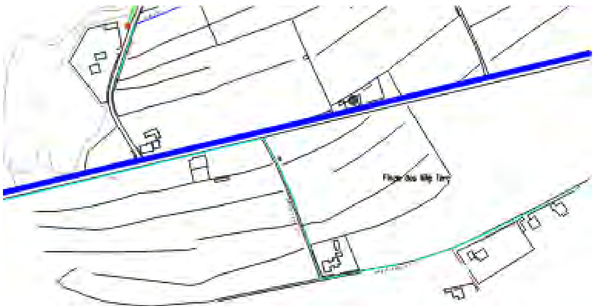
PROYECTO MEJORA RED MUNICIPAL ABASTECIMINETO: TUBERÍA TRANSPORTE INTERCONEXIÓN A BOMBEO PUIG CARDONA
