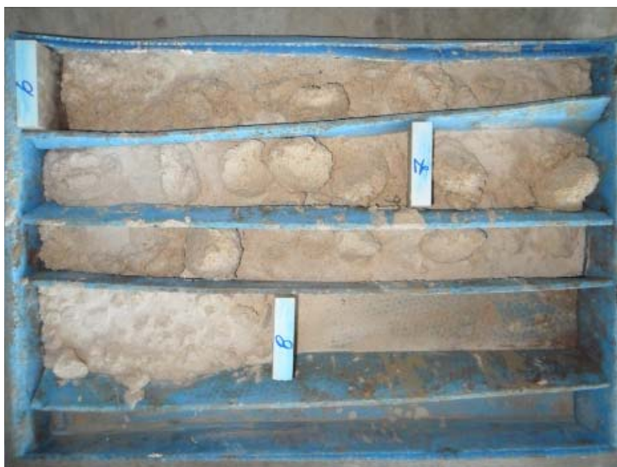
Foto 12: Caja porta testigos SONDEO 2 CAJA 3
