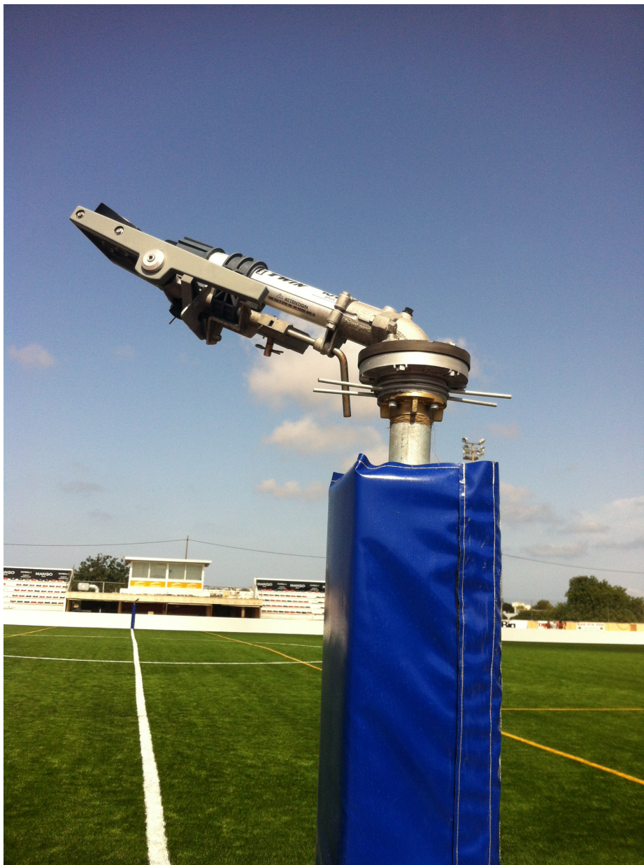
Detalle prolongación cañones de riego
