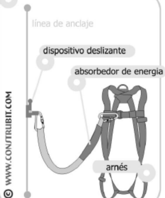
con línea de anclaje rígida
